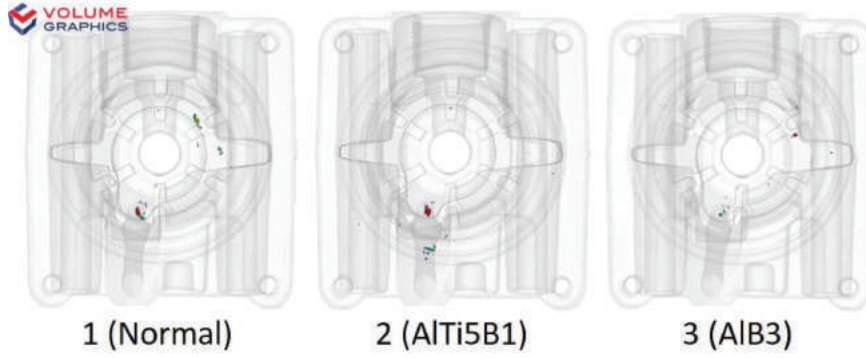
Şekil 3.3: Parçaların CT analiz sonuçları, %96 saydamlık
