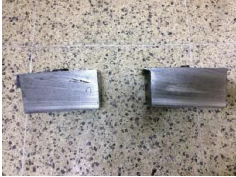
Şekil 8 Kesme sonrası döküm parçasının kesit görünümü
