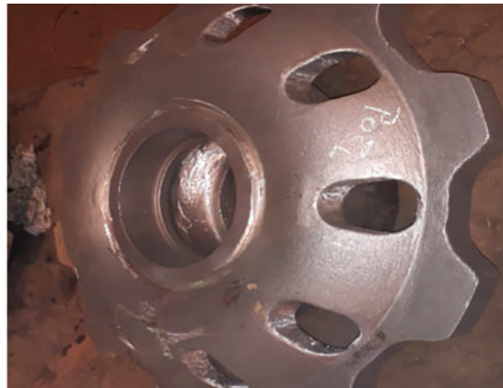
Şekil. 12c: Menevişleme sonrası MPI çatlama
