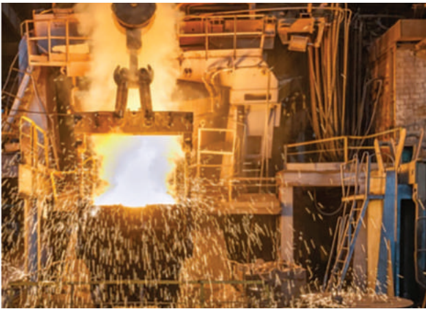
Şekil. 2c: Sıvı metal aktarımı, hava sürüklenmesine ve bifilme neden olur
