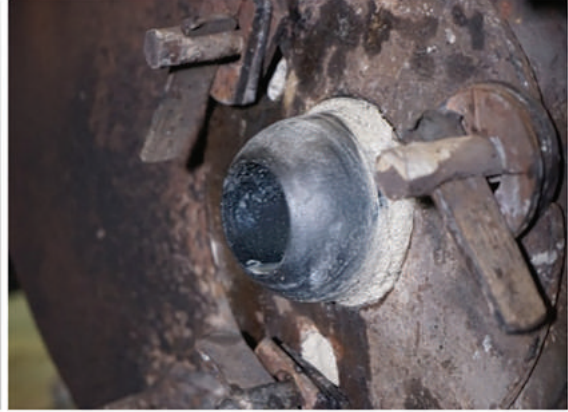
Şekil 8b: Kullanıma hazır pota üzerine monte edilmiş nozul
