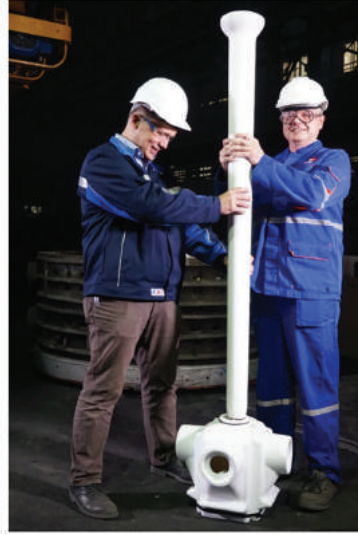
Şekil. 4b: Kalıp monte edildiğinde HOLLLOTEX Shroud filtre kutusuna gider
