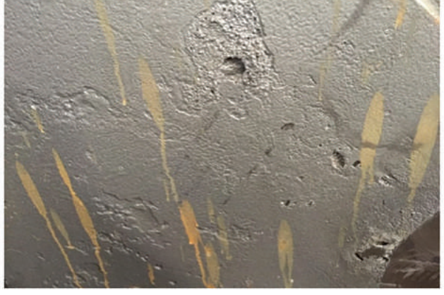
Şekil. 15b: Üst kısımdaki kum inklüzyonları
