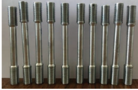
Şekil 2.4 Zamak 5 (soldan beşi) ve ZA 8 (sağdan beşi) alaşımlarından elde edilen çekme testi numuneleri
