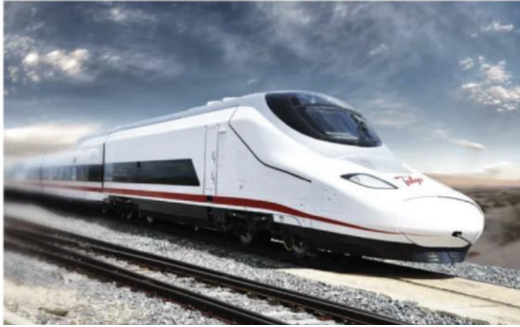
Şekil 17: Yeni hızlı tren ve metro vagonlarında alüminyum ve kompozitler kullanılmaktadır.
