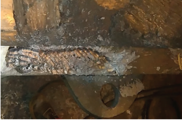
Şekil. 15a: Üst yüzeydeki tipik gaz deliği hataları
