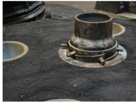
Şekil. 5b: kalıbın üstünde kaldırma sistemi
