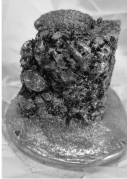
Şekil 5 : Tuzlu köpük karışımı ile üretilmiş köpük alüminyum
