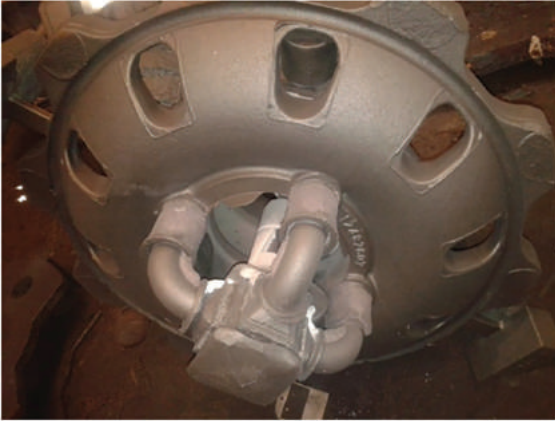
Şekil. 12a: HOLLLOTEX Shroud ile tekerlek gövdesi çatlama
