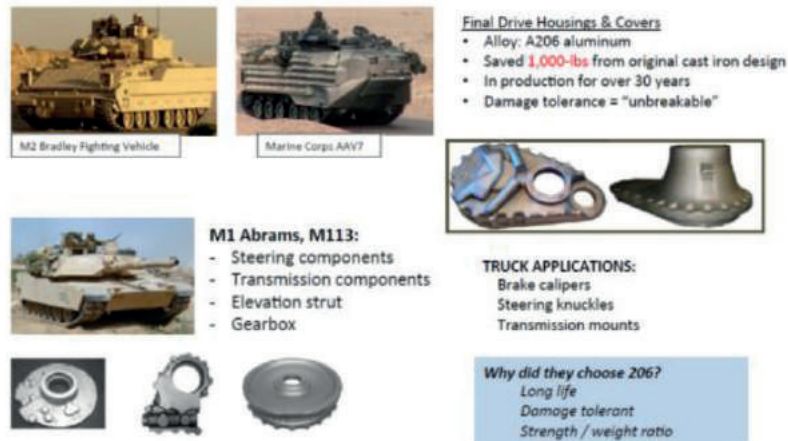
Şekil 19: Alüminyumun askeri araçlarda kullanımı
