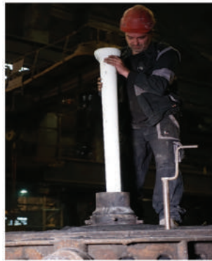
Şekil. 6a: Hazırlanmış kalıbın içerisine HOLLLOTEX Shroud yerleşimi
