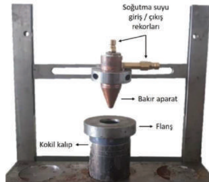
Şekil 2.1: Soğuk parmak test düzeneği
