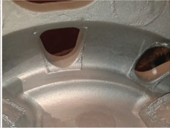
Şekil. 12b: Kumlama sonrası üst derece döküm yüzeyi
