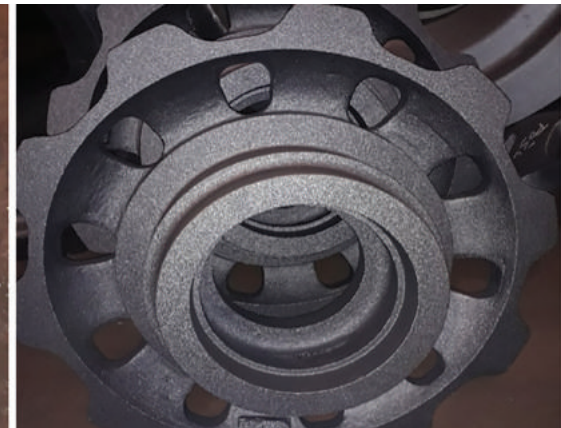
Şekil. 12d: Ultrasonik ve MPI kontrolleri sonrası üst derece döküm yüzeyi
