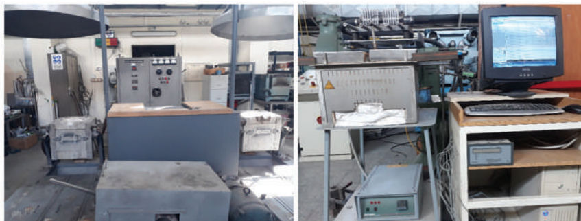
Şekil 10: 25 kg çelik kapasiteli indüksiyon ocağı (solda), titreşim cihazı ve termal analiz kurulumu (sağda)
