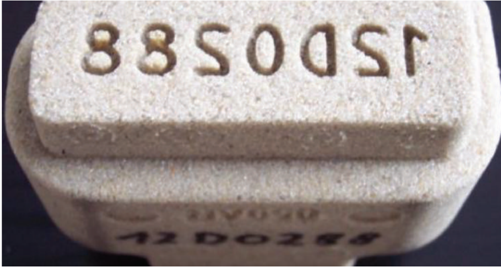
Resim 5: Inspektomation lazer sistemi ile markalanmış maça
