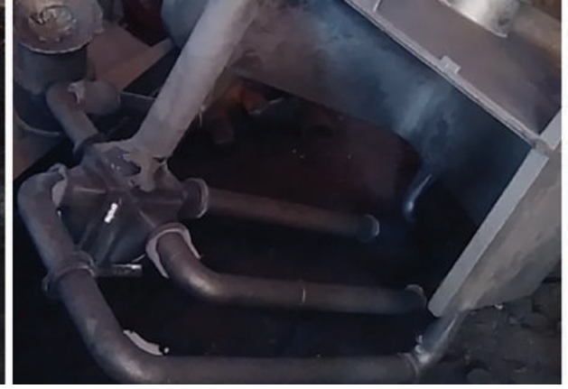
Şekil. 16b: HOLLOTEX Shroud ile döküm - kumlanmış yolluk sistemi
