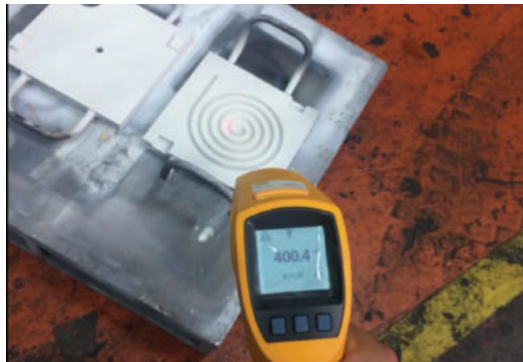
Şekil 2. Döküm yapılmadan hemen önceki kalıp sıcaklığı
