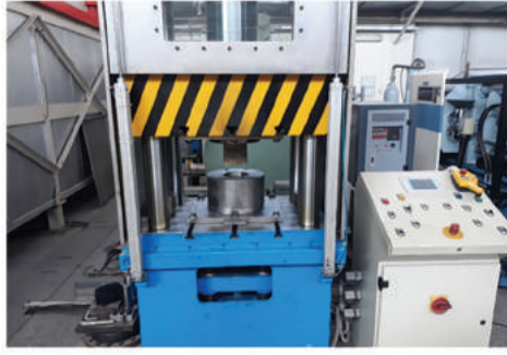
Şekil 11: Reodöküm deneylerinde kullanılan dik basınçlı pres
