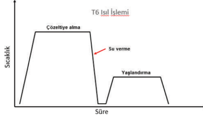
Şekil 1 : T6 Isıl işlemi şematik gösterimi
