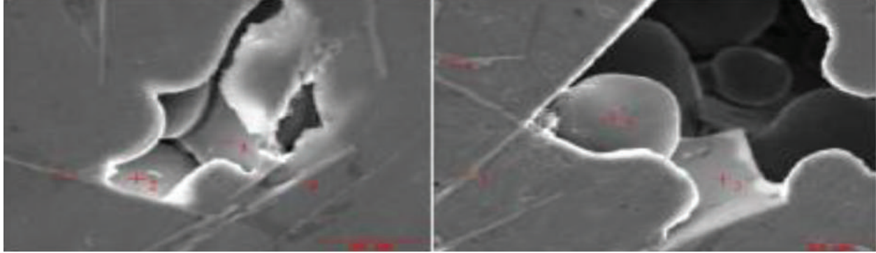
Şekil 5. 24 saat bekletilen A380 alaşımının kum kalıp orta basamak SEM görüntüleri
