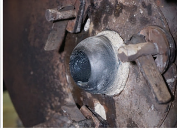
Şekil 9b: Kullanıma hazır pota üzerine monte edilmiş nozul
