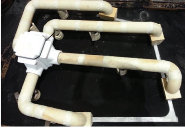
Şekil. 16a: HOLLOTEX Shroud filtre kutusu takılı yolluk sistemi
