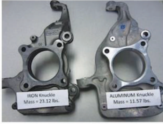
Şekil 13: Araçlarda alçak basınç ve kokil döküm metodu ile üretilen parçalar
