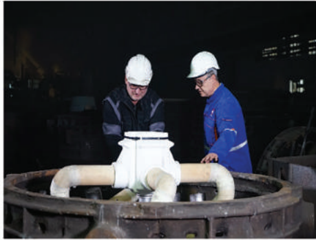
Şekil. 5a: Filtre kutusu ve alt dercede çalışan sistem kurulumu
