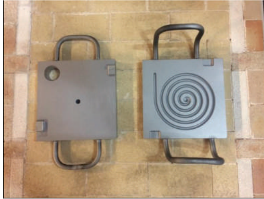
Şekil 1. Spiral Akışkanlık Test Kalıbı
