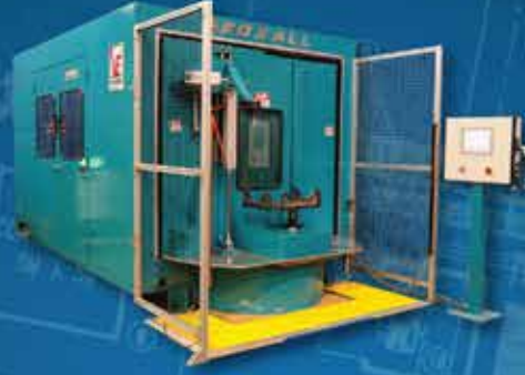
Automated Finishing Cells Ful otomatik çapak alma ünitesi
