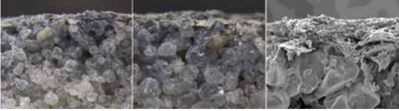
RESİM 4 Farklı büyüt- meler altında boyanmış kalıp yüzeyleri
