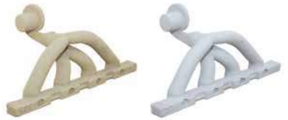
RESİM 2 Boyanmış ve boyanmamış maçaların karşılaştırılması
