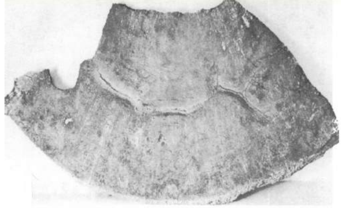
Şekil 9.7. Yetersiz kömür tozu veya yastıklama türü malzemeler nedeniyle oluşan damarlaşma (temizleme öncesi dart vardı).
