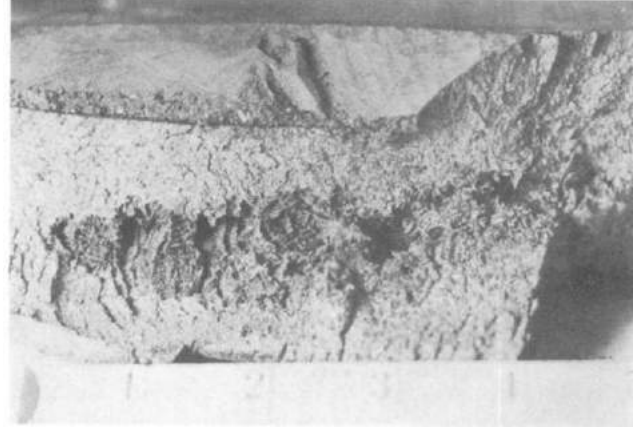
Şekil 28.1. Beslenemeyen kalın bir kesitte oluşan tipik bir çekinti boşluğu hatası.
