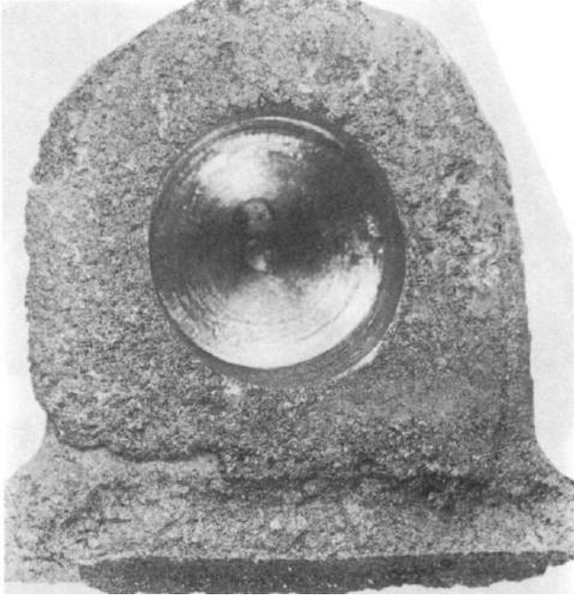
Şekil 10.2. Kumdaki aşırı nem, penetrasyona sebebiyet vererek, kalıp yüzeyinin parça yüzeyine tamamen kaynaması ile neticelenmiştir.
