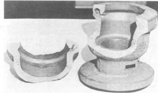
Şekil 11.11. Maça boyasının zedelenmesi sonucu oluşan gazın kalın kesitlere yönelmesi.
