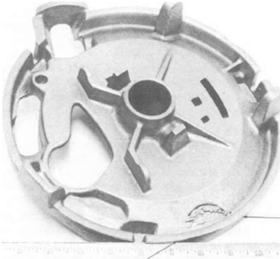
Şekil 5.2. Düşük kum mukavemetinin neden olduğu kum yalaması
