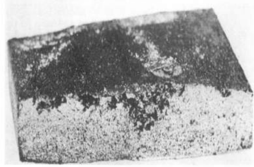
Şekil 3.2 Sfero dökme demirde curuf
