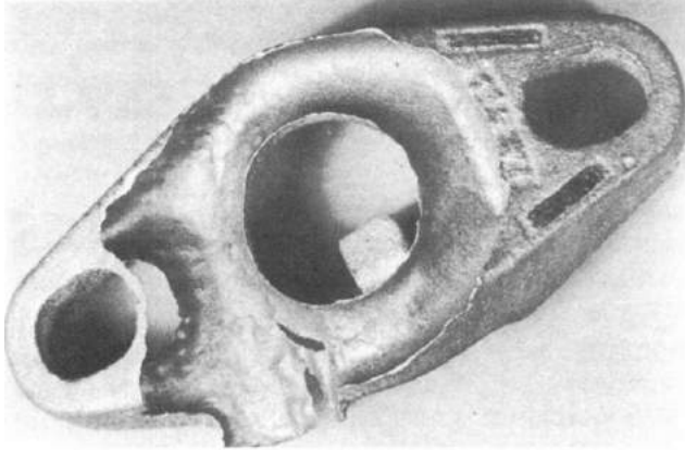
Şekil 24.9. Kalıp konveyör üzerinde hareket ederken ve katılaşmadan önce ceketlerin kaydırılması forsaya neden olmuştur. Başlangıçta kalıp doluydu.
