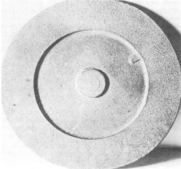
Şekil 22.1. Tipik bir kalıp esnemesi hatası görülen bir döküm parçası.
