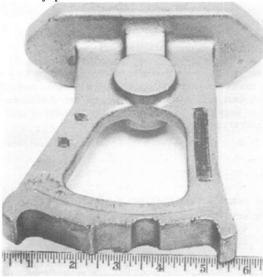
Şekil 27. 2. Kesintili dökümden kaynaklanan saçma.
