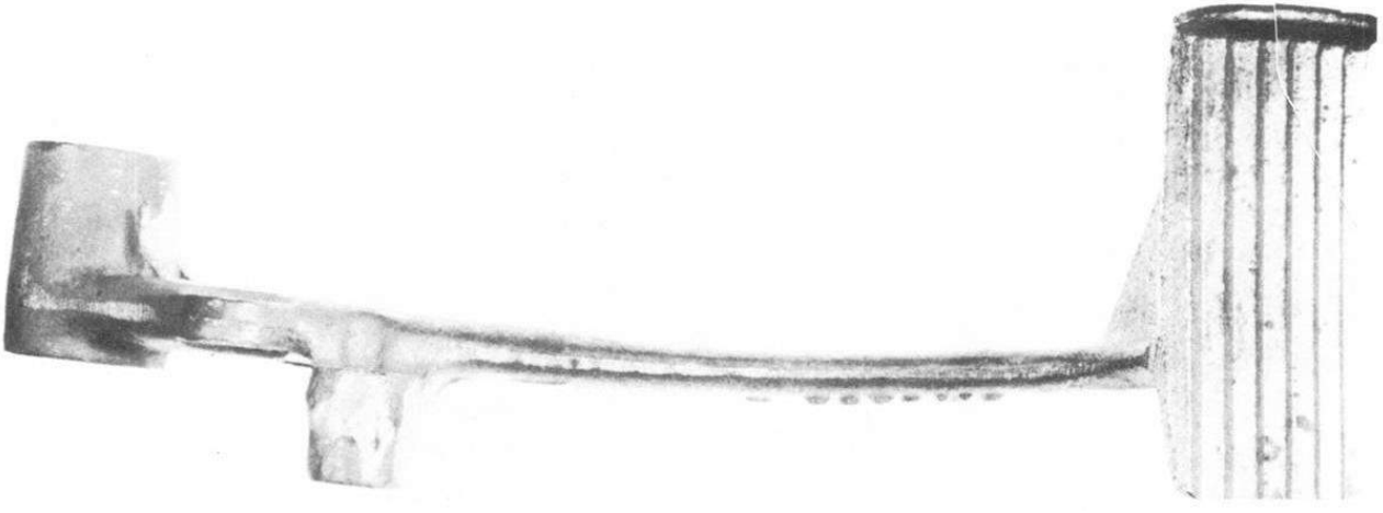
Şekil 32.3. Temperleme işleminden sonraki dengesiz soğuma parçada atıklığa yol açmıştır.
