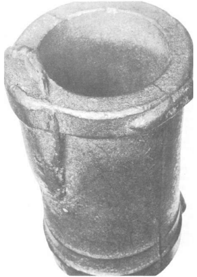
Şekil 30.2. Damarlı kalıp şişmesi
