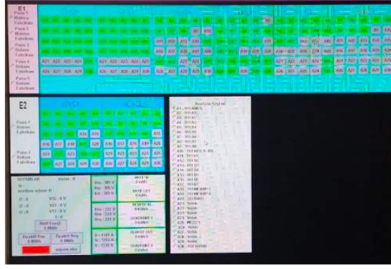
Şekil 5: SCADA takip ekranı
