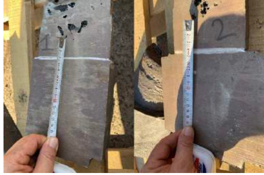
Şekil 9 : 1; A besleyici gömleğin kullanıldığı deneme dökümü sonrası besleyici gömlek metalinin çekinti görünümü, 2; B besleyici gömleğin kullanıldığı deneme dökümü sonrası besleyici gömlek metalinin çekinti görünümü.
