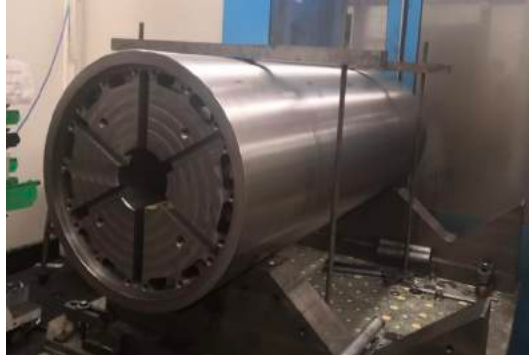
Şekil 3 : Çift cidarlı, duo akış sistemli merdane imalat fotoğrafı
