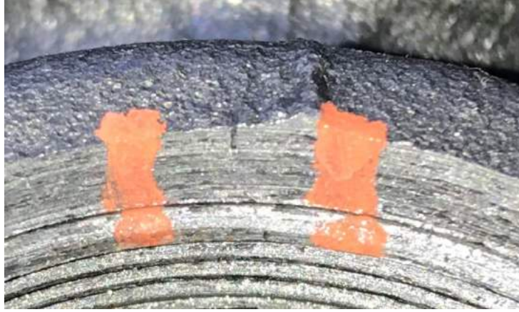
Resim 3: Diş açılmış boru ekleme parçasında sıcak yırtılma hatası
