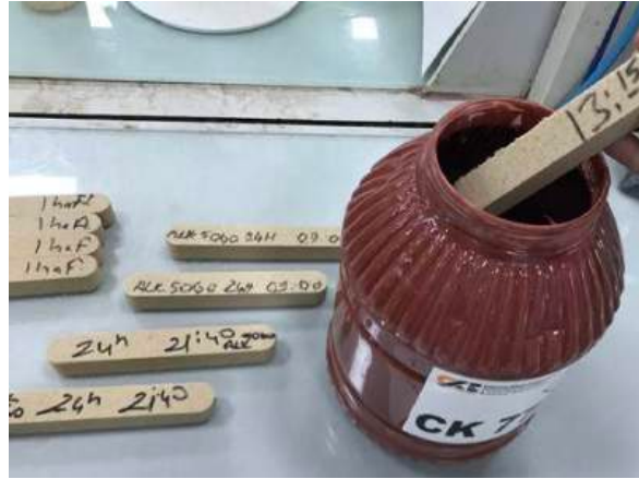
Şekil 3 : Alkafen maça numuneleri ve boyama işleminde kullanılan ÇK 782 A döküm boyası.
