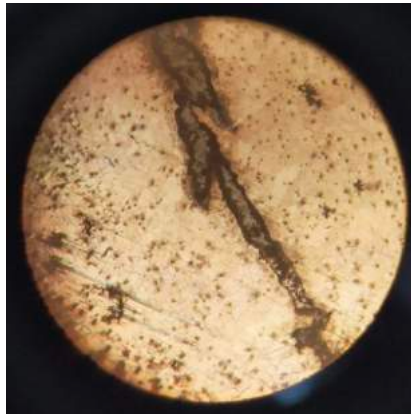
Resim 2: Temper dökme demirde sıcak yırtılma hatasının mikro yapısı
