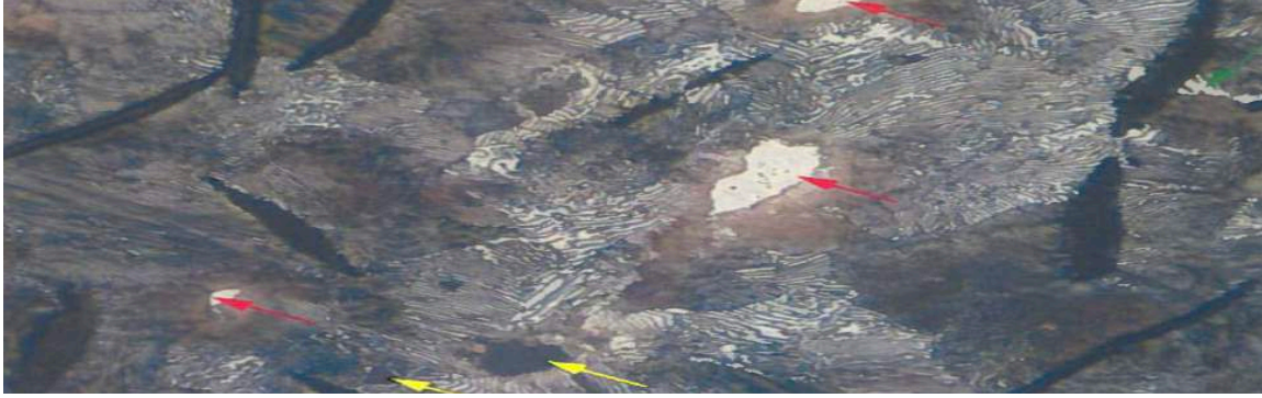
Resim 9 : Lamel Grafitli Dökme Demirde Steadit ve İnküzyon. Kırmızı Ok İle Gösterilen Steadit, Sarı Ok İle Gösterilen İnküzyon, Yeşil ok ile gösterilen ferrit ( % 2 Nital İle Dağlanmış Numune )
