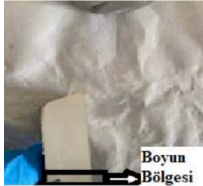
Şekil 10 : Döküm parçasından mikro yapı görüntüleri için alınan bölgenin gösterimi.
