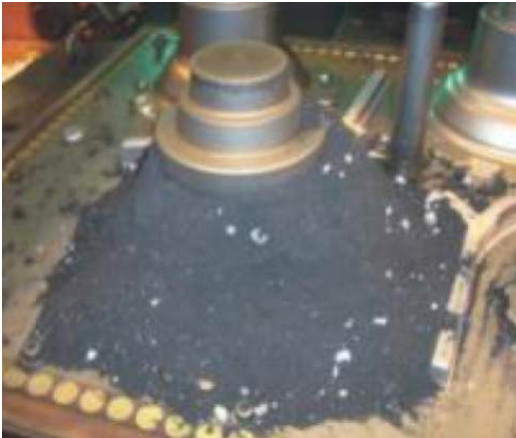
Şekil 2: Yanmamış besleyici gömlek kırıntılarının döküm kumuna eklenmesi [7].
