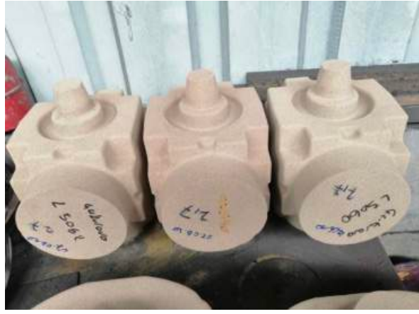
Şekil 4 : Saha denemelerinde karşılıklı olarak test edilen yeni reçineler ile yapılan maçalar.
