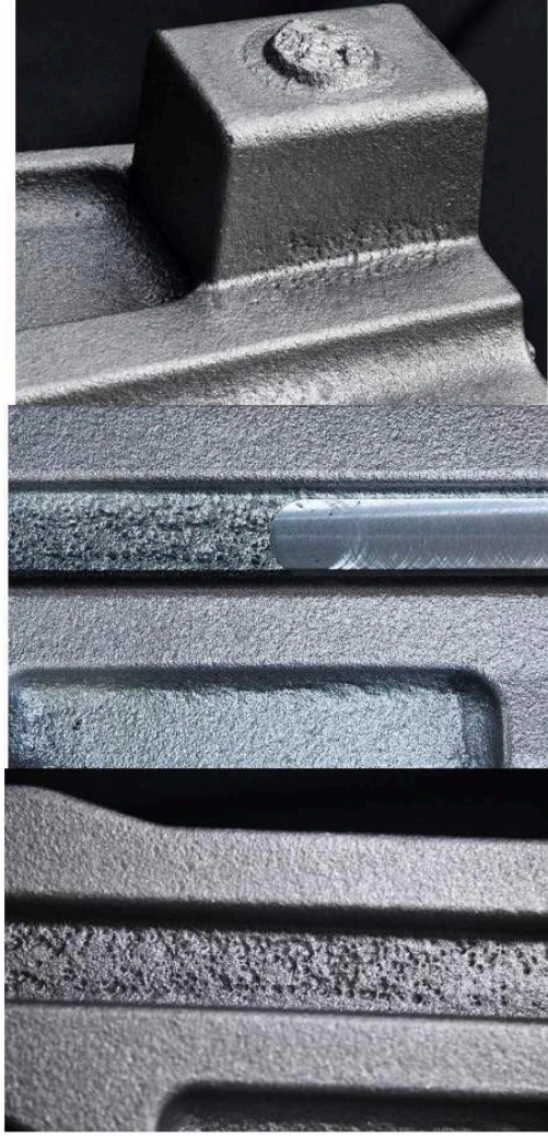
Şekil 6: Ferro Döküm Dış Ticaret A.Ş.'de görülen pitted surface hatasının görünümü.
