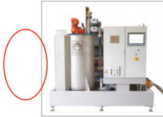
Şekil 3: ICU homojenizasyon tankı
