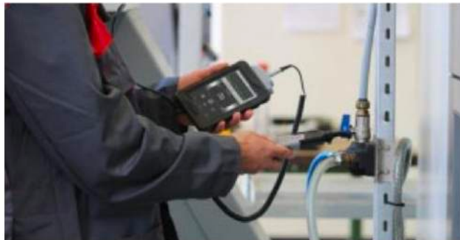
Şekil 9: Kaçak tespiti örnek çalışma
