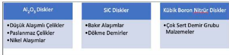
Şekil 5 : Al 2 O 3 , SiC ve CBN ( Kübik Boron Nitrür ) Disklerin Kullanıldığı Yerler [6]
