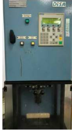
Şekil 2 : DISA elektronik dayanım ölçüm cihazı.
