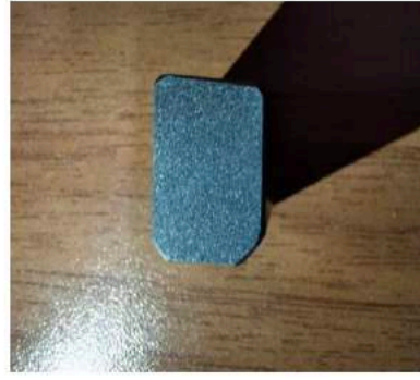
Resim 2 : %3 Nital ile uzun dağlanmış numune
