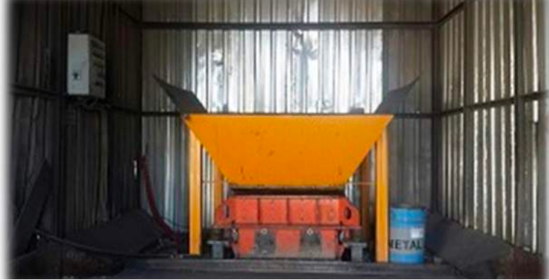
Şekil 3: Maça firesi için kırıcı kullanımı
