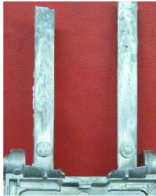
Şekil 17 : Hava tahliye kanalları
