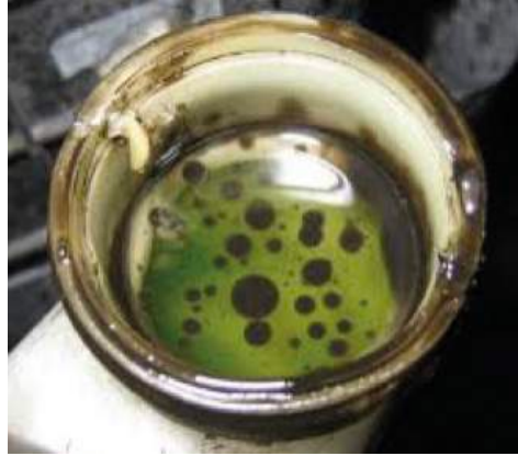
Şekil 2: Soğutma yağı içindeki kalıntılar
