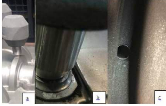
Şekil 6 : Yeni tasarlanan mini besleyici ile yapılan (a) kalıp, (b) besleyici bağlantı noktası, (c) kalıp içi görüntüleri.
