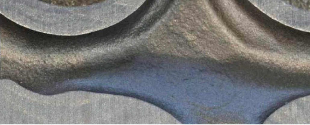
Şekil 7: Sarsak işleminden hemen sonra iç kesit yüzeyi
