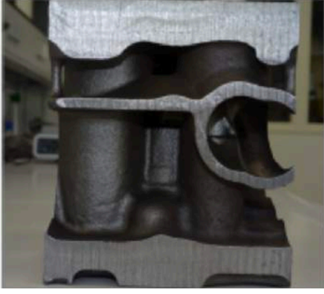
Şekil 6: Kumlamadan hemen sonra Döküm Yüzeyi
