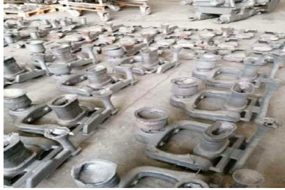
Şekil 7 : Basıncılı yolluk sistemi ile dökülen parçaların görseli.
