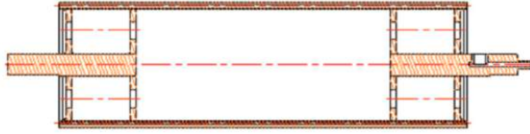
Şekil 2 : Çift cidarlı, duo akış sistemli merdane tasarımı [27]
