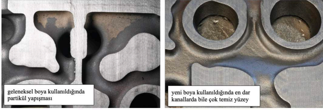
Şekil 9: Standard maça boyası ve iç temizlik boyası karşılaştırması
