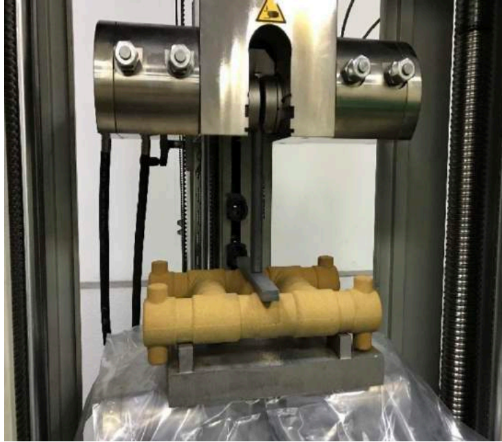
Resim 5: Basma testi ile maça mukavemetlerinin kontrol edilmesi
