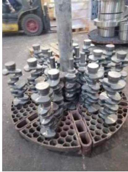
Şekil 4 : Östemperleme Denemelerinde Parçalara Uygun İmal Edilen Aparat ve Parça Yerleşimi
