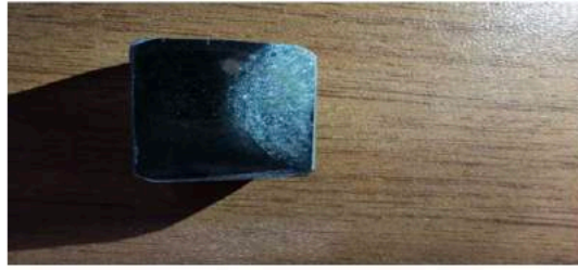
Resim 3: Yeterli parlatma yapılmadığı için dağlama sıvısının homojen olarak dağılmaması
