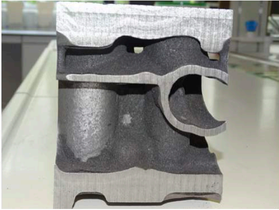
Şekil 8: Kumlama işleminden hemen sonra iç kesit yüzeyi.
