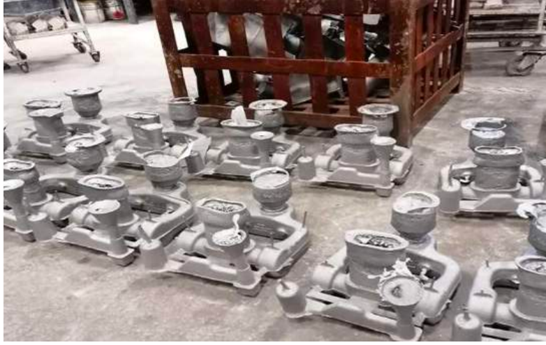
Şekil 11 : Spin Trap haznesi ile dökülen parçaların görseli.
