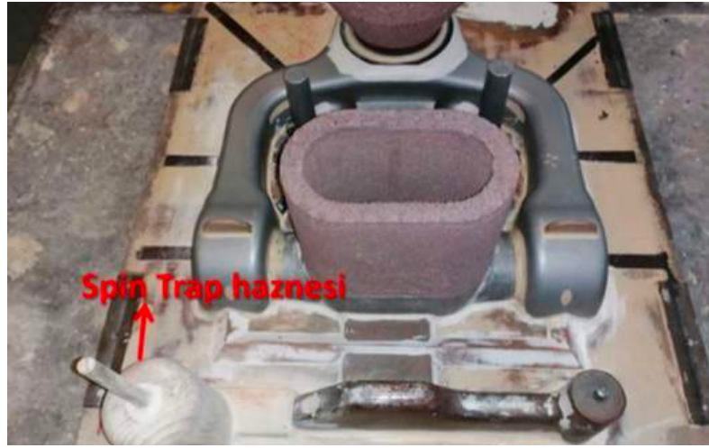
Şekil 10 : Parça modelinde basınçlı yolluk sistemine montajlanan Spin Trap haznesinin gösterimi.
