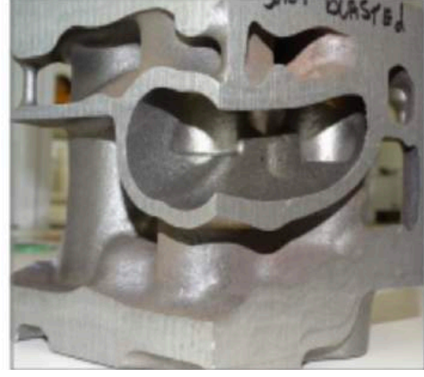
Şekil 6: Kumlamadan hemen sonra Döküm Yüzeyi
