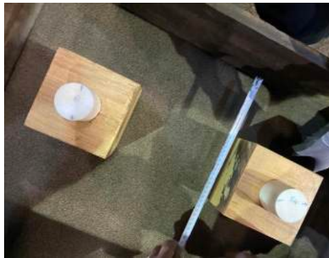
Şekil 7 : Deneme dökümü kalıbın hazırlanması.
