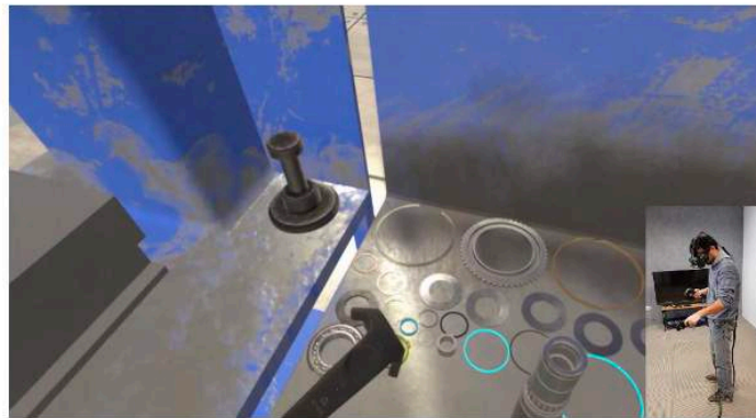
Resim 3. Türk Traktör fabrikasında montaj eğitimi için kullanılan arttırılmış gerçeklik uygulamasından bir görüntü. Büyük resim, sağ alt köşedeki katılımcının gözlükleri aracılığıyla gördüğü görüntüyü göstermektedir [11].
