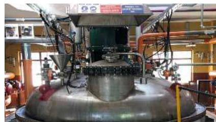
Şekil 3: 30 m³ Hacimli Yeni Reaktör
