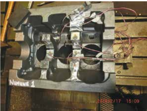
ŞEKİL 6 Kesilmiş motor bloğu
