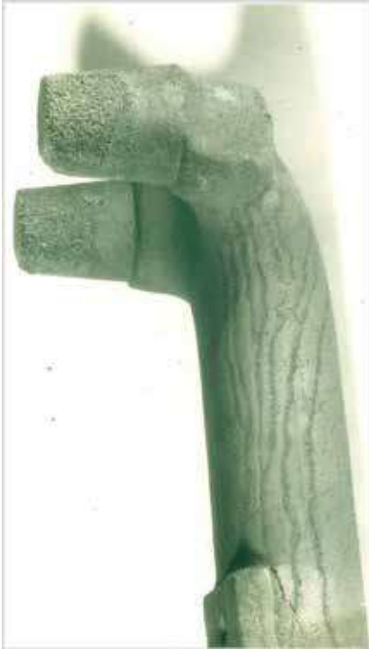
Şekil 3. Bakteriden etkilenen boyayı uygularken sinerez
