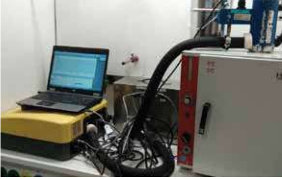
Şekil 5. FTIR (Fourier Dönüşümlü Kızılötesi) test kurulumu
