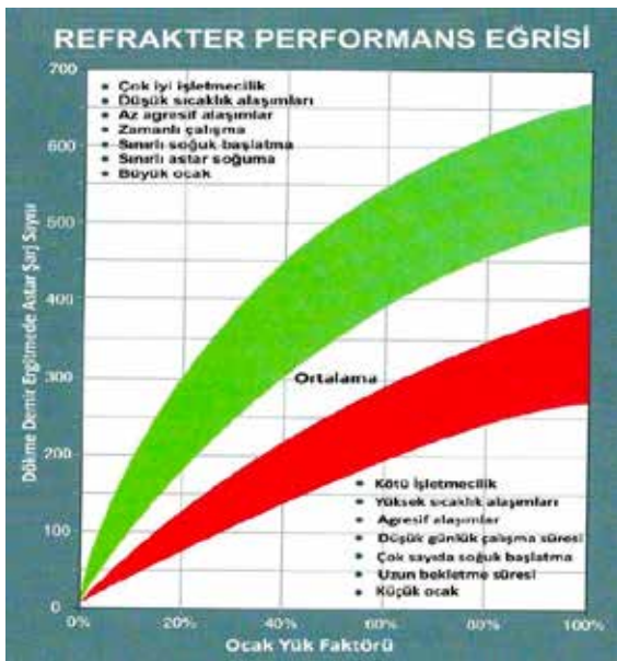
Şekil 11: Refrakter Ömrünün Değişimi (Ref 2)
