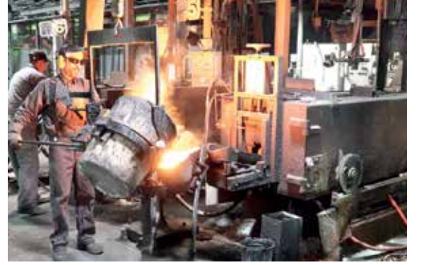
▲ Yatay santrifüj döküm prosesinde üretilen iki metre uzunluğundaki gri dökme demir borular
