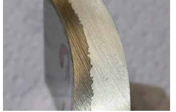
Püskürtme çubuğuyla uygulanan boya
