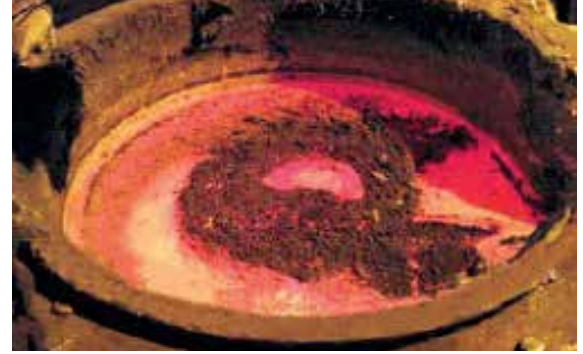
Grafik 11: COVERAL MTS 1582 ile yapılan tretman sonrası transfer potası içindeki kuru curufa ait fotoğraf
