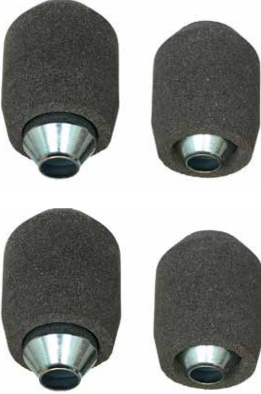
Figür 5a Yeni Besleyici Gömleği kavramı katlanmadan önce ve sonra – genellikle döküm parça ile besleyici gömleği esas kısmı arasında 8 - 15 mm mesafe var (VAK)
