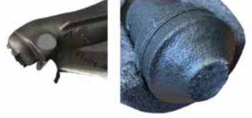
Figür 7 Yeni noktasal besleyici kavramı besleyicinin kopartma sonucu – daha fazla taşlama işi gerektirmeyen temiz yüzeyli sağlam parça
