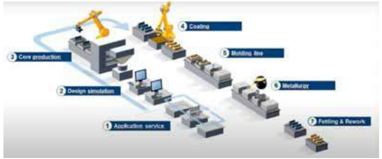
Şekil 2: Dökümhanedeki basitleştirilmiş süreçler
