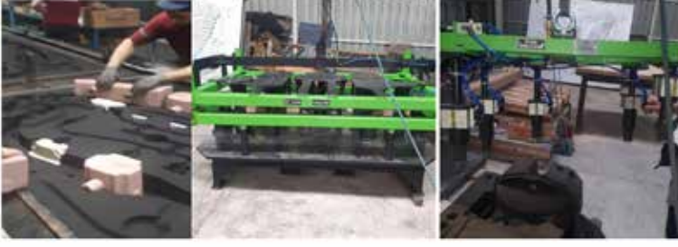
Şekil 1: Elle maça yerleşimi Şekil 2: Pim Merkezlemeli Aparat Şekil 3: Merkezlemesiz aparat
