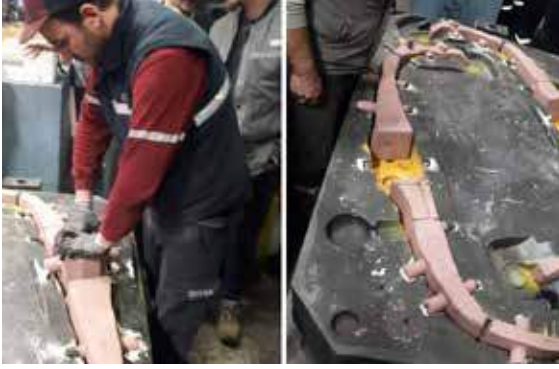
▲ Şekil 8/9: Alt kopya kalıba , ergonomik maça yerleştirme ve yerleşmiş konum
