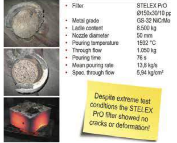
Şekil 5: Temas çekirdekli bir XTA8 içine yerleştirilen STELEX Pro Ø150x30/10 ppi ile yapılan akış denemesinin sonucu, filtrenin üstten (a), alttan (b) ve 1050 kg ağırlığındaki döküm bloktan (c) döküldükten sonraki görünümü
