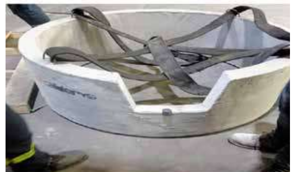
Resim 3: Ocak Ölçülerine Göre Calderys Firmasından Gelen Precast
