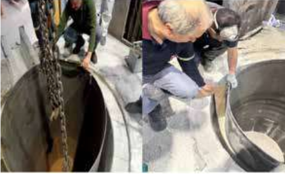
Resim 4: Ocak Astarı Dövüldükten Sonra Precast Betonunun Hizalanması İçin Yapılan Öz Hazırlıklar
