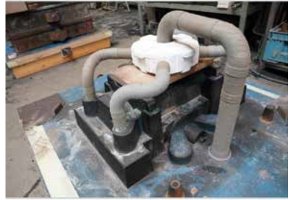
Figür 1: a+b. Montaja hazır yolluk sistemi. Geçmeli bağlantısı sayesinde kolay montaj.
